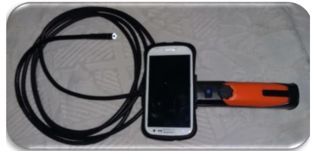
Figura 1: Equipo endoscopio inalámbrico industrial acondicionado para la inseminación artificial intrauterina.
