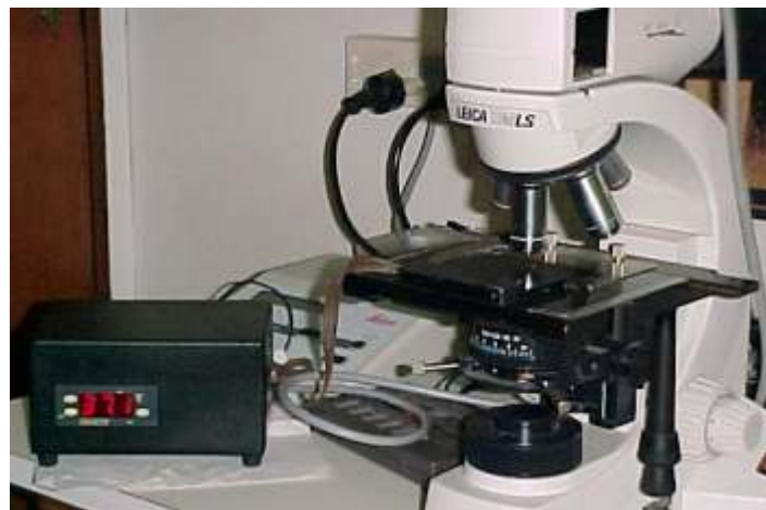
Microscopio de contraste de fase con Platina térmica, para evaluación de semen
